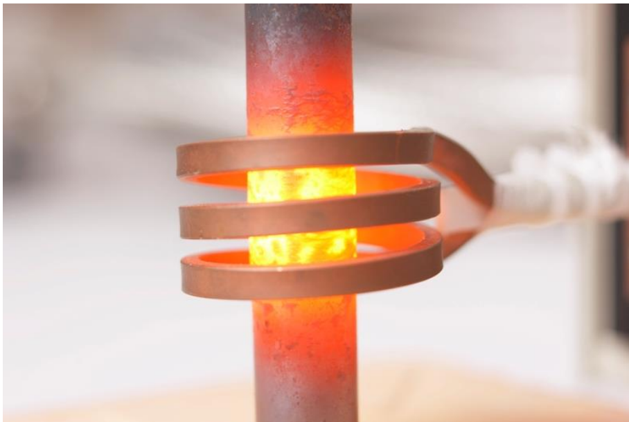
Bild: Erwärmung eines Stahlrohres
